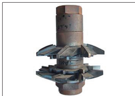
ΞΕΛΟΥΡΙΣΤΙΚΟΣ ΔΙΣΚΟΣ ΠΑΤΖΟΥΡΙΟΥ MILLING COMPONENT FOR SHUTTER
