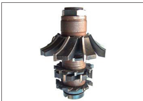
ΞΕΛΟΥΡΙΣΤΙΚΟΣ ΔΙΣΚΟΣ ΚΑΣΑΣ MILLING COMPONENT FOR CASE
